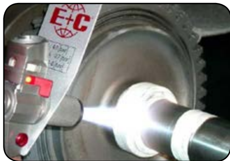
Восстановление посадочного места вала порошком на основе никеля RotoTec® 19940
