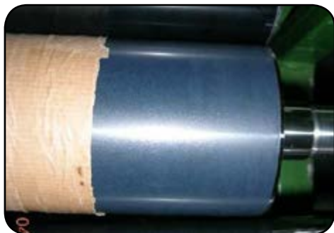
MetaCeram® 28030. Вал печатной машины
