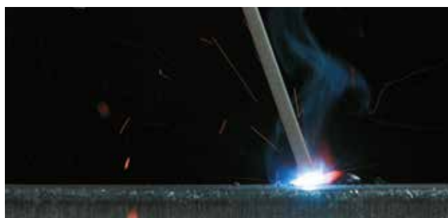
1) Электрод - 2) Флюсовая оболочка - 3) Металлический сердечник 4) Дуга- 5) Защитная атмосфера- 6) Сварочная ванна- 7) Шлак 8) Наплавленный материал- 9) Основной металл
